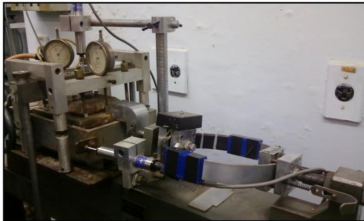
Figura 7b – Anel de carga (vista lateral)
